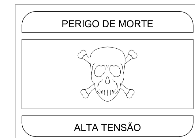
7 DETALHE - PLACA DE ADVERTÊNCIA - PL ESCALA: SEM
